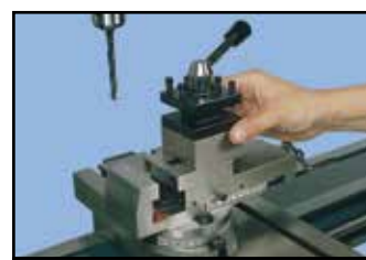
Odmontováním nožové hlavy máme k dispozici svěrák
